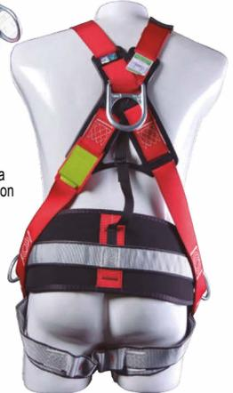
fabricado en reatas de poliéster de alta tenacidad de 6.800 lb. Anillos en "D" con resistencia de 6.200 lb, costuras en poliéster de alta tenacidad con tratamiento UV.
